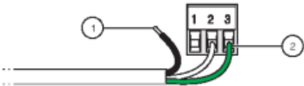
图 3-13 正确的导线制作及插入
