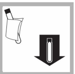
9、擦干净试管外壁，将试管插到光度计的试管固定架上。
