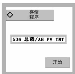
2、打开 DR2800，点击“存储程序”，选择：536 总磷 /AH PV TNT 点击“开始”。
