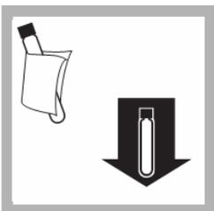
13、擦干净试管外壁，将试管插到光度计的试管固定架上。
