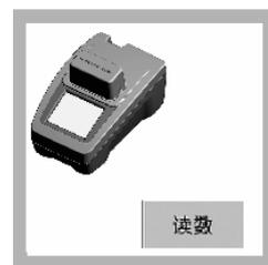
14、盖上遮光罩，点击“读数”进行测量，结果以：mg/L PO<sub>4</sub><sup>3-</sup> 表示<sup>①</sup>。
