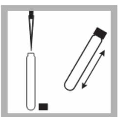
8、用移液管移取 2 mL 1.54N 的氢氧化钠溶液 (27430-42) 到试管中。拧紧盖子后混合均匀。
