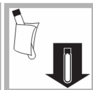
8、擦干净空白试管外壁, 放入 DR5000 的试管样品架上。
