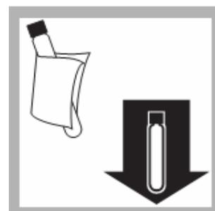
10、擦干净样品试管外壁, 放入 DR5000 的试管样品架上。
