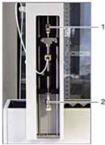
图76 调整注射器活塞
