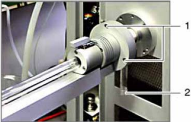
图 103 安装固体测定模块
