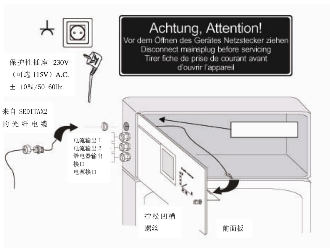
图 7 SEDITAX 2 光纤电缆和信号线的布线图
