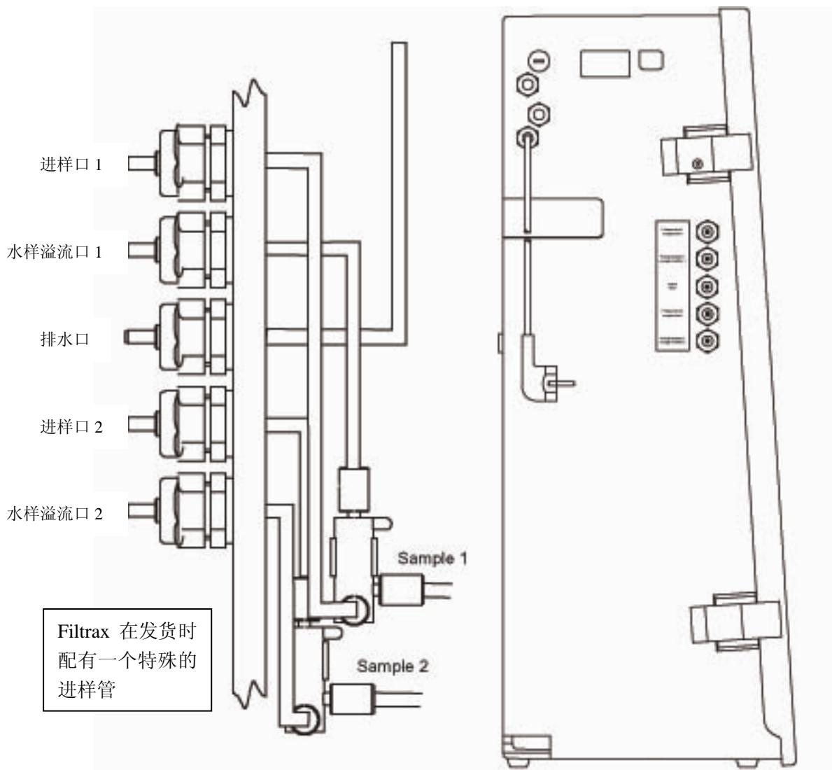
图 6 双通道模式下的管路连接
