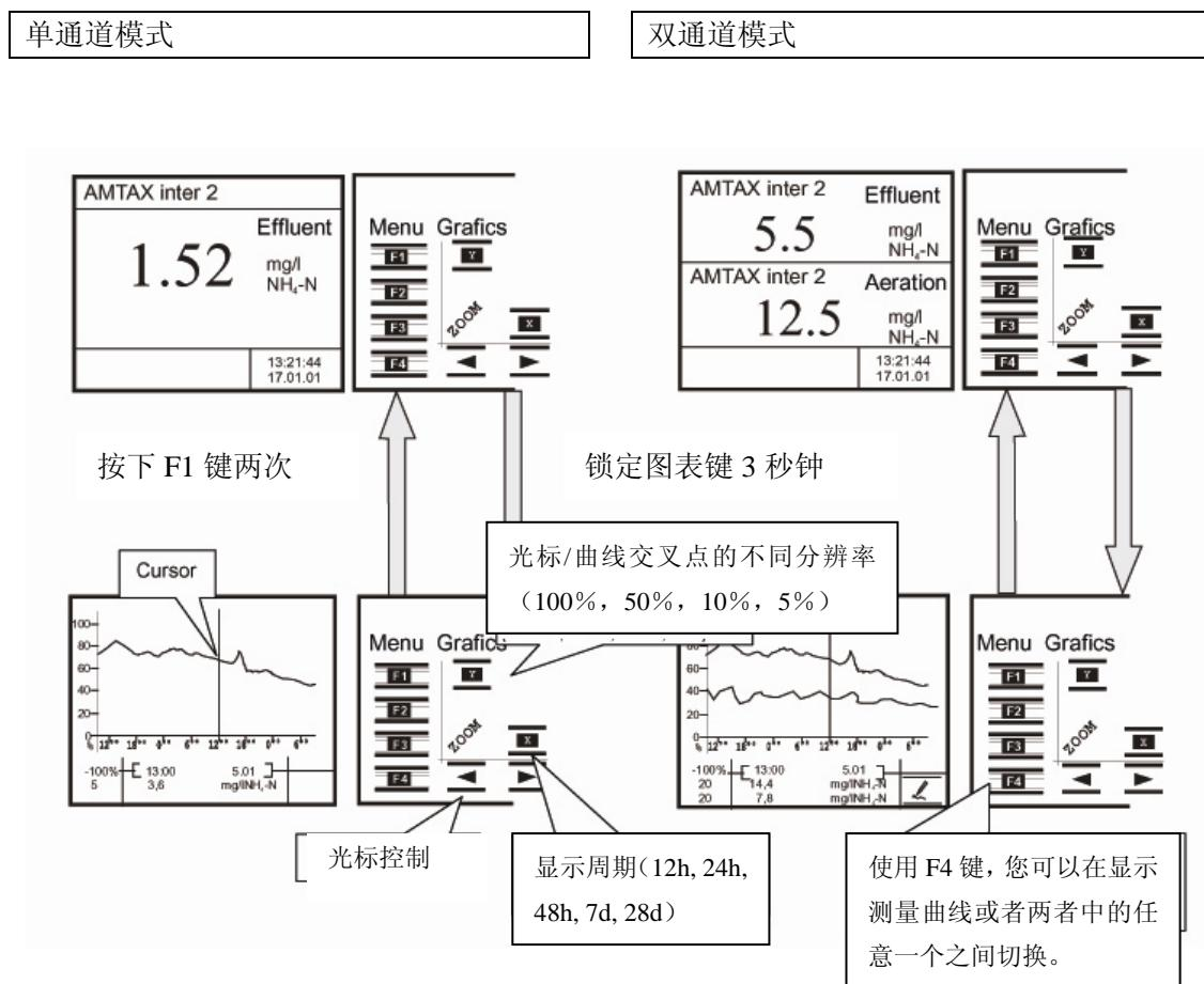
图 12 测量数据图表的变化
