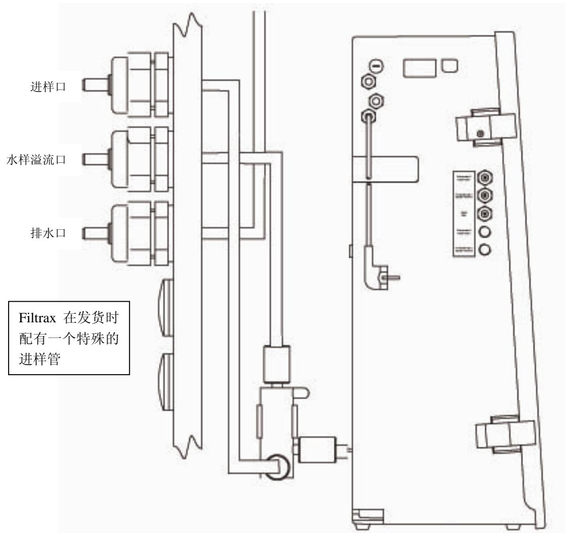
图 5 FILTRAX 的管路连接
