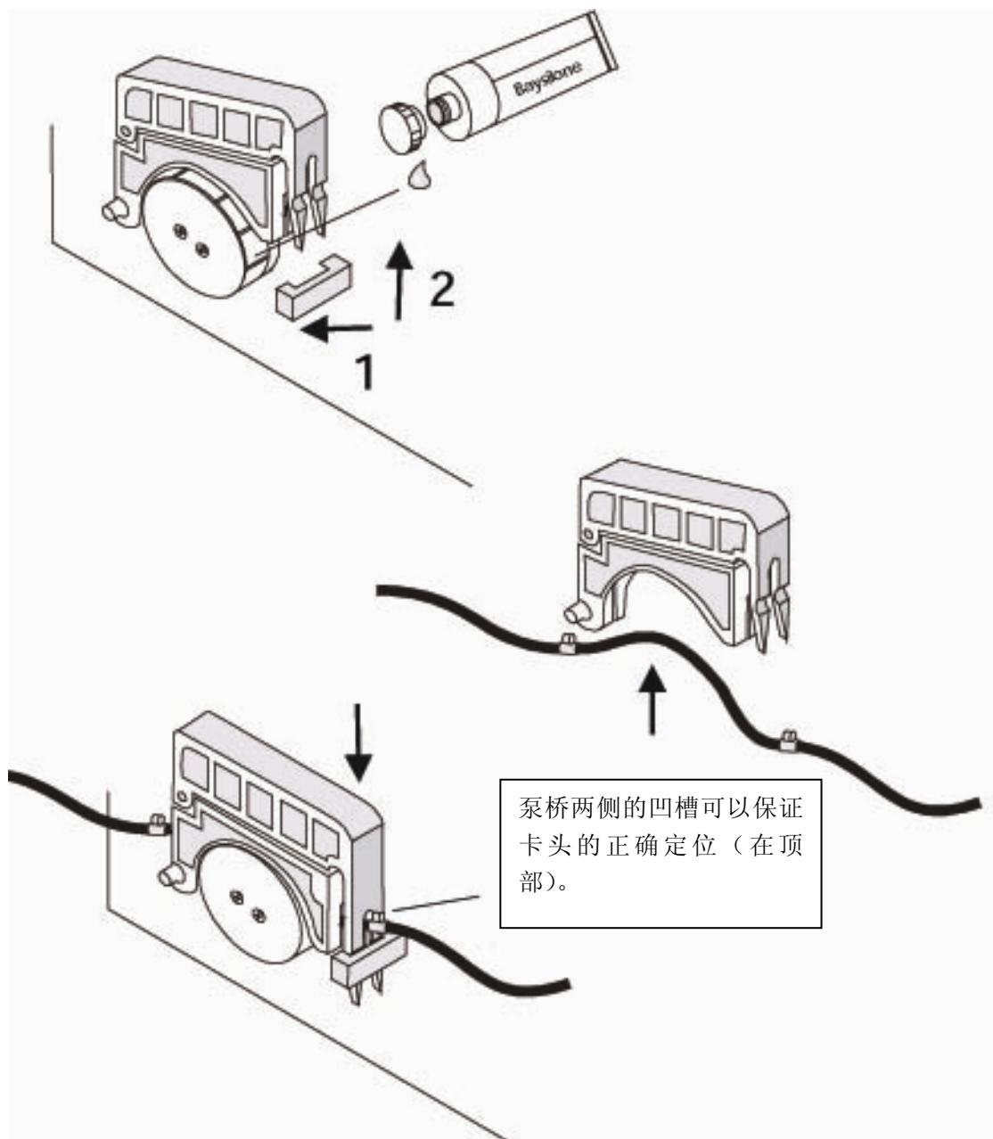
图9 更换仪器的管路
