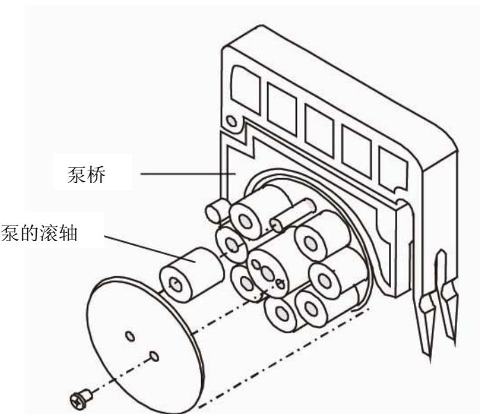
图 13 更换泵的滚轴时，蠕动泵的泵头
